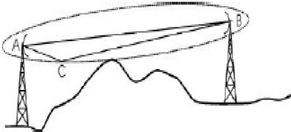
Σχήμα 2.12. Σχεδίαση Ραδιοζεύξης έτσι ώστε τα εμπόδια να βρίσκονται εκτός της 1 ης ζώνης Fresnel.
